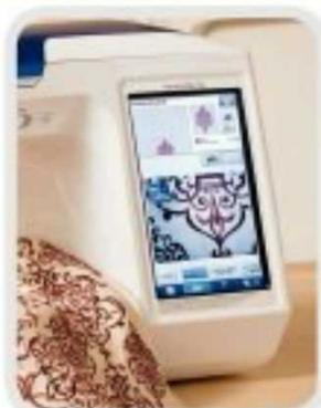
ASV HD LCD дисплей размером 8,5 дюймов по диагонали и углом обзора 176 град с возможностью передать 16,7 млн оттенков цветов
